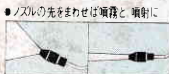
ノズルの先をまわせば噴霧と噴射に 噴霧で広範囲に 噴射で集中的に
